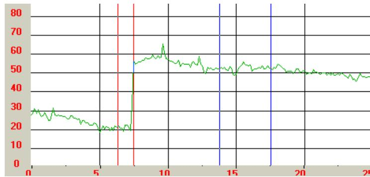
Abb. 4.4: Höhenprofil entlang einer Schnittachse, bezogen auf den tiefsten gemessenen Punkt des gesamten Scans. Linker Bereich: ITO. Rechter Bereich: ITO +PEDOT:PSS. Achsen: Höhe [nm] über Profilposition [ $\mu\text{m}$ ].
