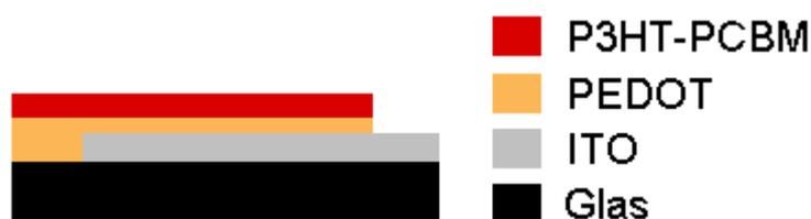
Abb. 3.2: schematischer Querschnitt zur Darstellung der Materialschichtung.
